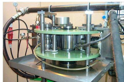
*Prüfstand zum Testen der Nockenwellen-Kolben-Verbindung.*
